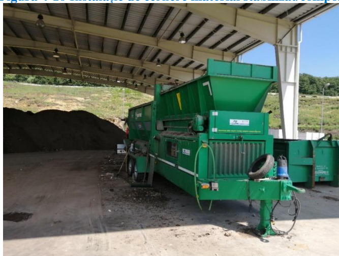
Figura 4-16 Instalație de cernere material stabilizat/compost
